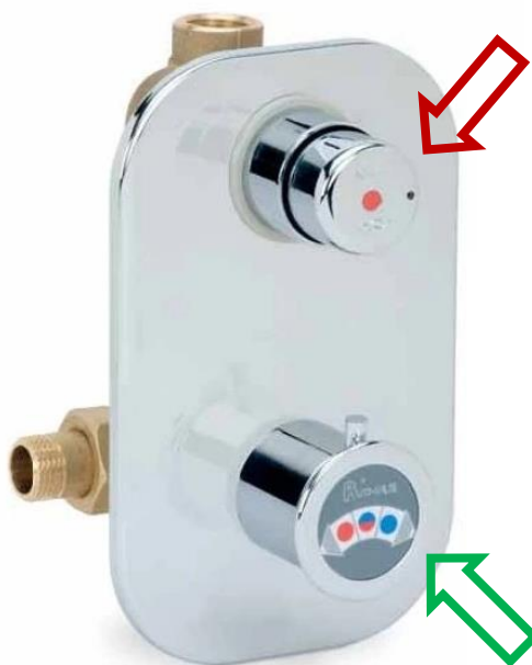
Obrázek 5: Referenční tlačný sprchový časový podomítkový směšovací ventil. Spodní zelená šipka ukazuje zabudovanou směšovací kartuši, červená šipka ukazuje na samotný tlačný ventil, který pouští vodu do hlavové sprchy
