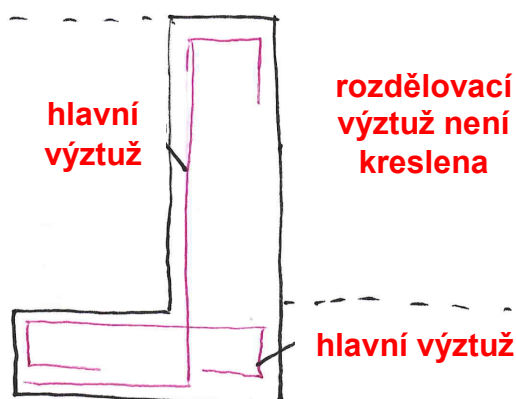
Obr. 3.1 - Schéma vyztužení opěrných zdí
