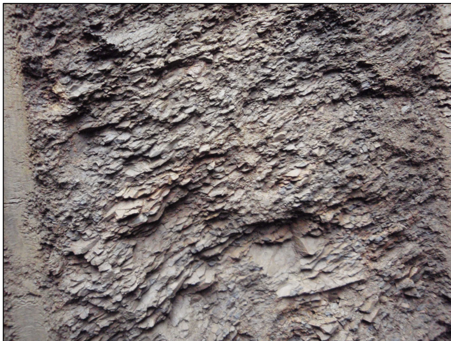
Foto 3 střípkovitě rozpadavá, tenké vrstevnatá zvětralina břidlice GT3
