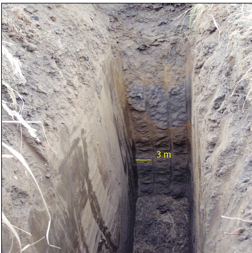
Foto 2 pohled do sondy K6 – v hloubce 3 m je patrný přechod žlutošedé zvětraliny GT 3 do šedého štěrkovitého rozpadu GT 4
